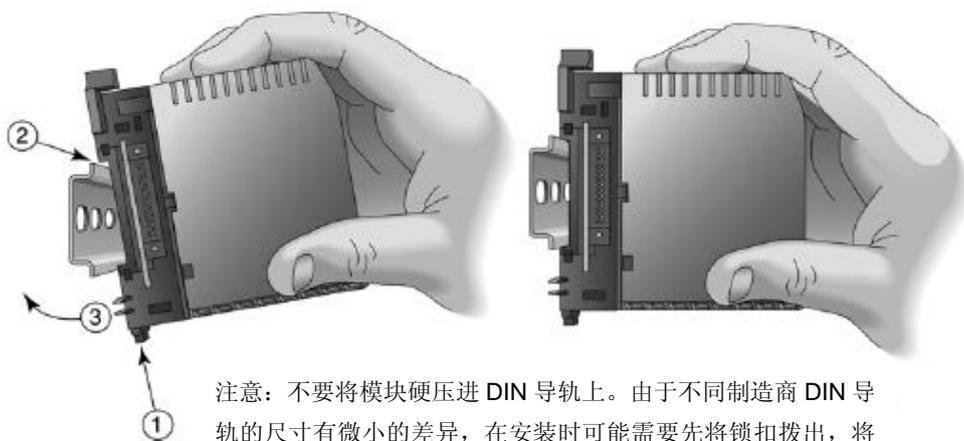
注意：不要将模块硬压进 DIN 导轨上。由于不同制造商 DIN 导轨的尺寸有微小的差异，在安装时可能需要先将锁扣拨出，将模块安装到位，然后再锁住锁扣。
