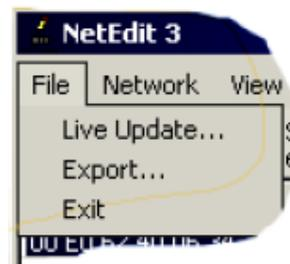
在 Live Update 窗口中单击 GO!按钮, NetEdit3 将对照你电脑上的文件与 Host Engineers 的 web 站点的版本信息进行比较, 并会下载最新的文件。完成后, NetEdit3 将重新扫描网络上的设备并刷新列表设备旁的“F”和“B”栏。
